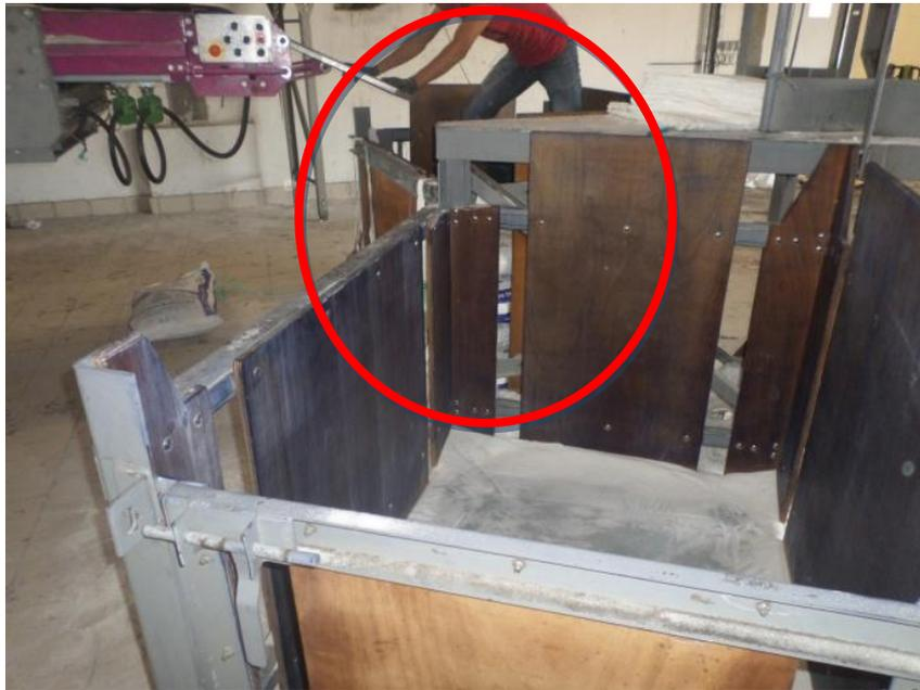
Figure 52: caisse de remplissage
