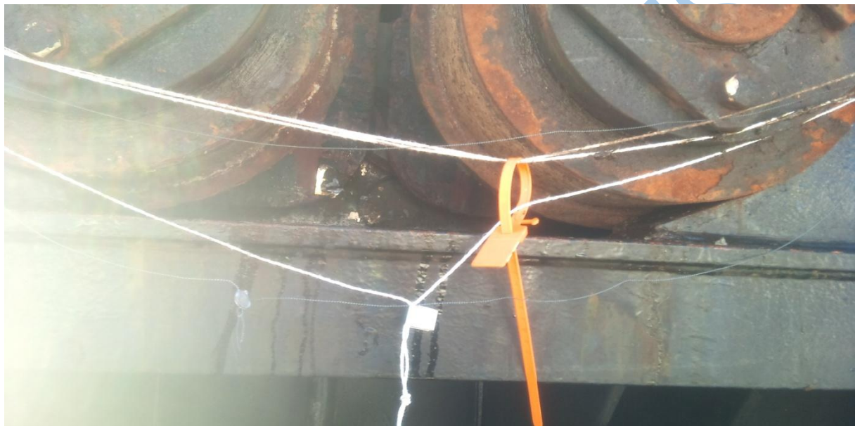
Figure 24:plombage au niveau des cales
