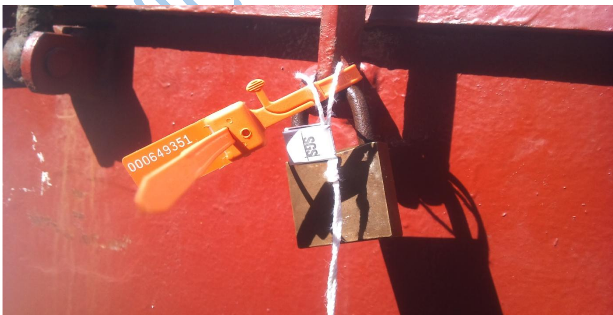
Figure 25:plombage au niveau des entres pour les cales
