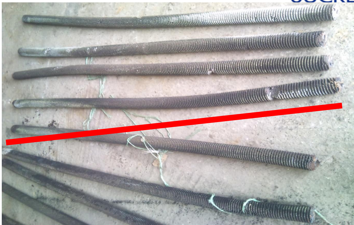
Figure 45 : vue de dessus (tube déformées) ECO.
